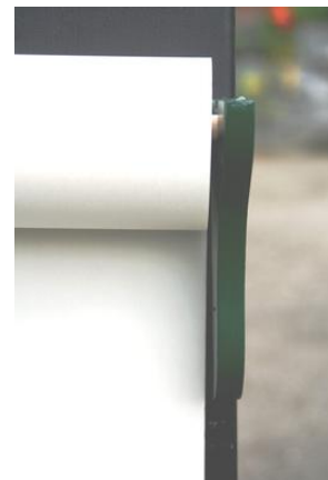
Support du rouleau de papier, avec de petits cubes magnétiques collés sur le devant
