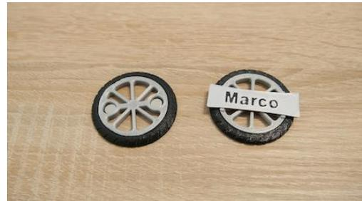
J'ai collé dans chaque roue deux des disques magnétiques mentionnés avec la colle "UHU MAX REPAIR". Deux autres aimants du même type ont été placés à l'intérieur du vêtement pour assurer le maintien des porte-badges. Grâce à la technologie d'impression 3D, le pneu noir peut même tourner autour de la jante.
