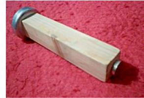
Grâce à la puissance du CSN-48, cet outil adhère aux contre-fiches en acier, même à travers une plaque de plâtre (BA13) de 13 mm d'épaisseur.
