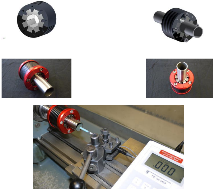
Les 4 unités d'aimants permanents quadripolaires montées sur l'accélérateur
