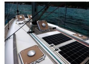
Ces couvertures sont maintenues sur le côté extérieur de chaque écoutille à l'aide de 6 disques magnétiques 20x7mm ([www.supermagnete.fr/S-20-07-N](http://www.supermagnete.fr/S-20-07-N)). Afin de les protéger contre la corrosion due à leur utilisation à l'extérieur et au contact avec de l'eau salée, l'apprêt époxy AWLGRIP 545 a été appliqué en plusieurs couches sur les aimants.
