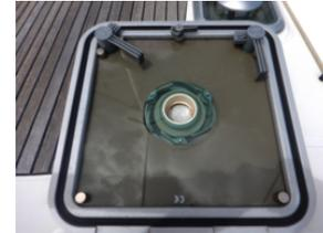
La distance entre les aimants s'élève à 8 mm (7 mm pour la vitre, presque 1 mm pour le tissu et un peu de peinture). Et pourtant, ces couvertures ont déjà résisté à des vents allant jusqu'à 40 nœuds sans se déplacer ni s'enlever.
