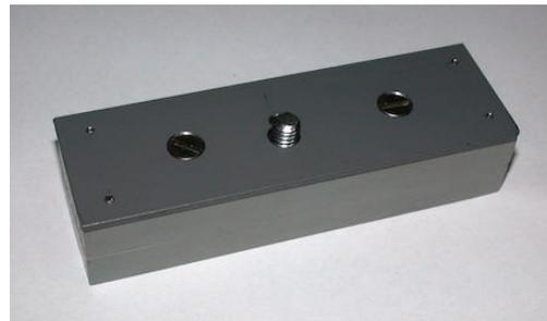
Les quatre trous de 1,1 mm dans la plaque en métal servent à stabiliser la caméra.
