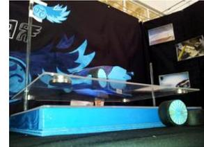
Per far fluttuare stabilmente la lastra superiore sopra quella inferiore abbiamo praticato un foro rispettivamente davanti e dietro le due lastre e le abbiamo collegate con due aste sufficientemente lunghe.
