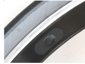
Il Supermagnete incollato in dettaglio
