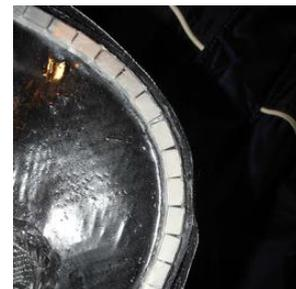
Damit kein Wasser in das Boot eindringt, habe ich über die Magnete im unteren Teil schließlich eine dreieckige Silikondichtung geformt.
