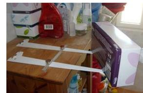
Wollen wir die Box nach links oder rechts drehen, nehmen wir einen Scheibenmagneten weg, verschieben die Schienen entsprechend und platzieren den Scheibenmagneten wieder auf dem Riemen.
