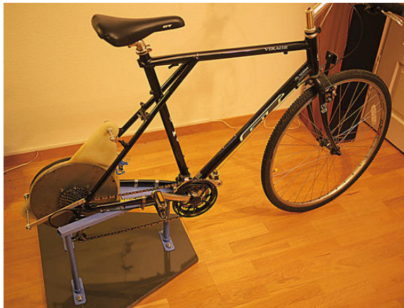
Ein 24-Gang-Fahrrad wurde aufgebockt und zum Generator umfunktioniert
