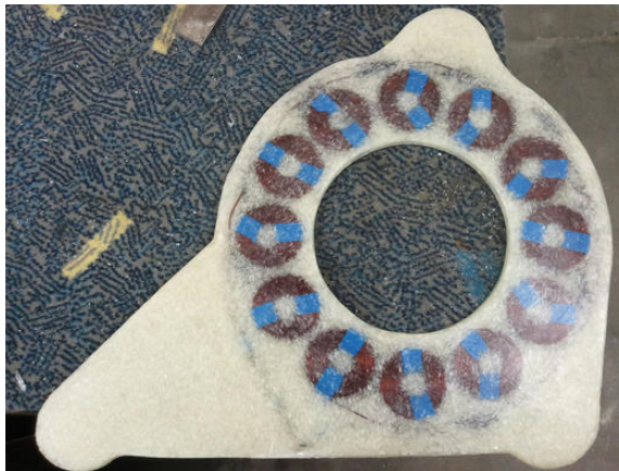
Der Stator: 12 in Epoxidharz eingebettete Spulen, dreiphasig angeordnet
