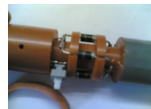
Alle Einzelteile vor dem Zusammenbau, die Spule ist bereits Schutzlackiert und zur Sicherheit abgeklebt.
