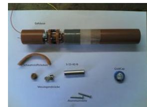
Alle Einzelteile vor dem Zusammenbau, die Spule ist bereits Schutzlackiert und zur Sicherheit abgeklebt.
